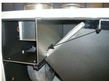
Bolzen zur Fixierung des Filterhalters
