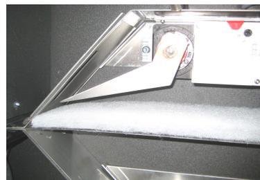
Beim Filterwechsel auf sauberen Sitz achten, damit die Klappe gut funktioniert
