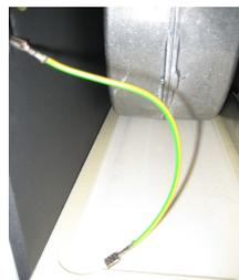
Erdungskabel an der Türe entfernen beim WRG 400 und vor dem Verschießen des Deckels wieder anbringen.
